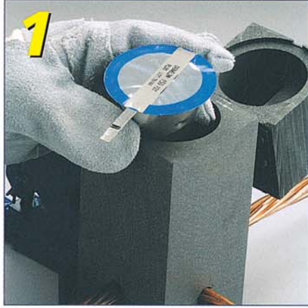
Adım 1: Cadweld Plus ambalajı pota içine yerleştirilir.
